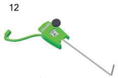
Distanzstück entfernen! Mit mitgeliefertem Inbusschlüssel vorsichtig Federelemente herausschieben.
