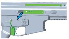
Kabel von GSB entfernen. Abzugsschalter entfernen.
