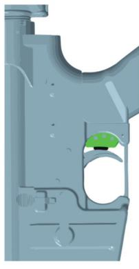
Vor dem Einbau Distanzstück auswählen und Abzugsmechanismus hinter dem Abzug platzieren.
