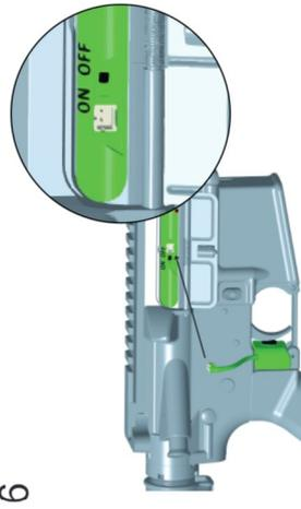
Kabel mit WLB 15 verbinden und Hauptschalter auf "ON" stellen.
