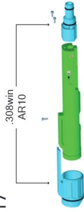
.308win (AR10): Spitze für .308win montieren (siehe Punkt 16). Hinteren O-Ring vom Gehäuse entfernen. Führungsbuchse für .308win in Schwalbenschwanz schieben und mit Inbusschraube fixieren.
