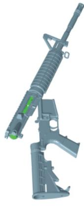
Originalen Verschluss ausbauen. WLB 15 mit der Spitze zuerst in das Patronenlager führen.
