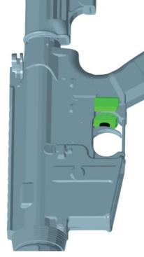
Abzugschalter mit Gegenplatte sichern.
